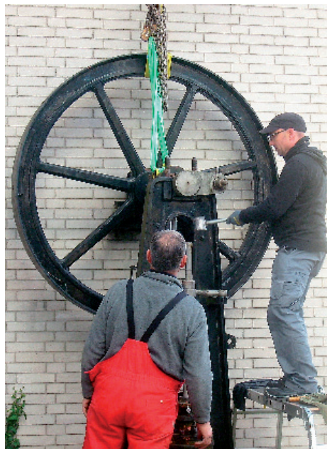
Mit dem Bleihammer werden die festsitzenden Lager gelockert.
