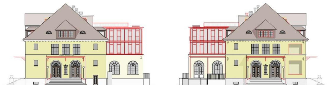
Abb. 3 Ost- und Westfassade ehem. Kosthaus mit Aufbau über Küchentrakt
