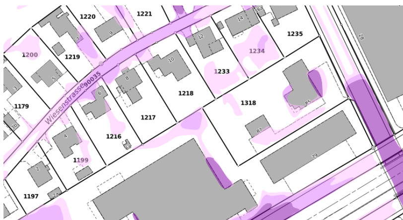
Abbildung 9: Gefährdungskarte Oberflächenabfluss (WebGIS Kt. SO, Okt. 2025)
