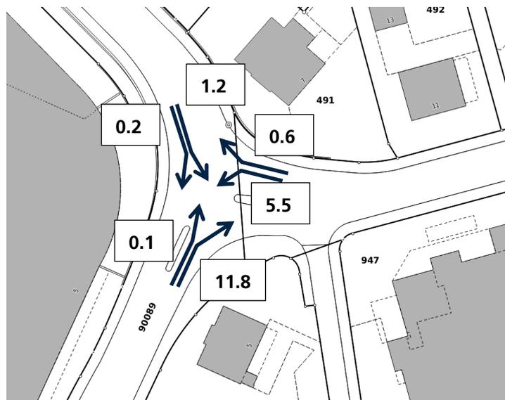
Abbildung 9 Mehrbelastung Knoten Gösgerstrasse-C.F. Ballystrasse während der ASP
